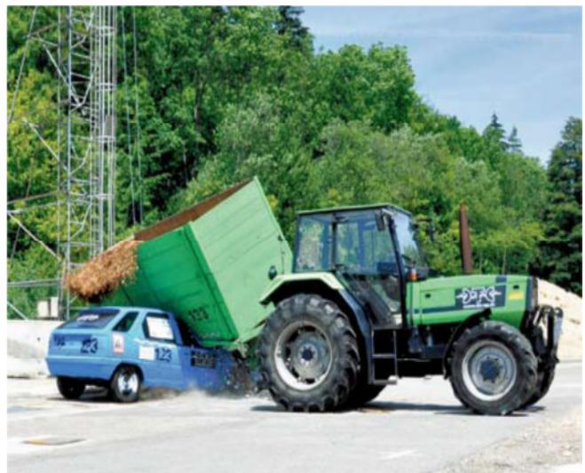
Ein PW rast mit 60 km/h ungebremst in einen mit Holzschnitzel geladenen Anhänger
